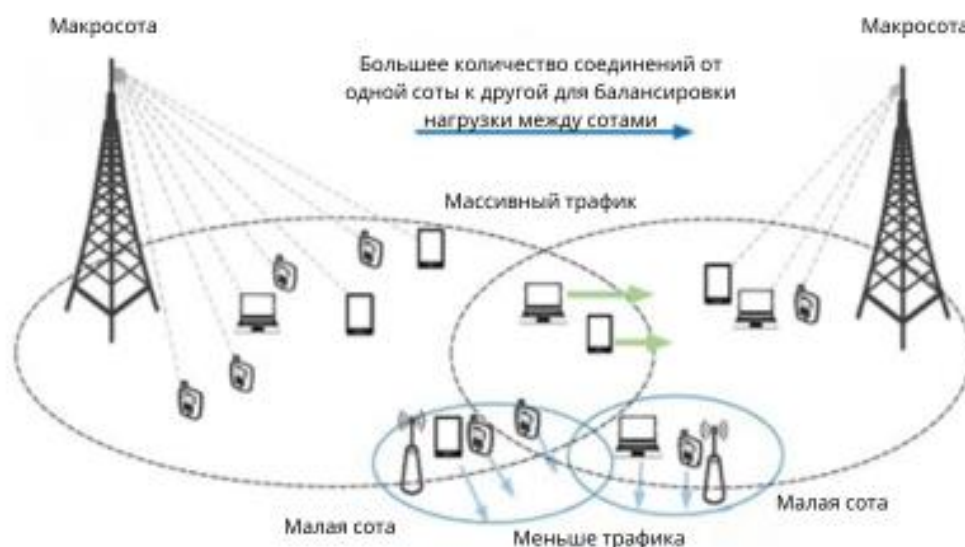
Рисунок 14 – Распределение нагрузки между ячейками на основе доступной ёмкости системы: пользователи, находящиеся на границе макроячеек с высокой нагрузкой, будут перенаправлены в ближайшие малые ячейки с более низким уровнем трафика или в макроячейки с относительно меньшей загрузкой
